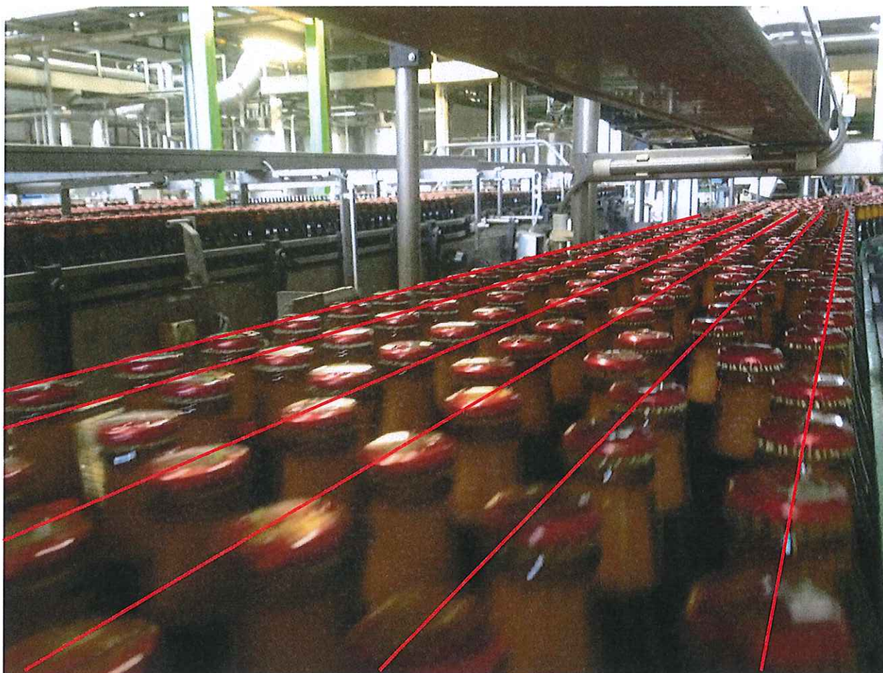
Flessen staan niet in lijn -> zijgeleiding te breed
